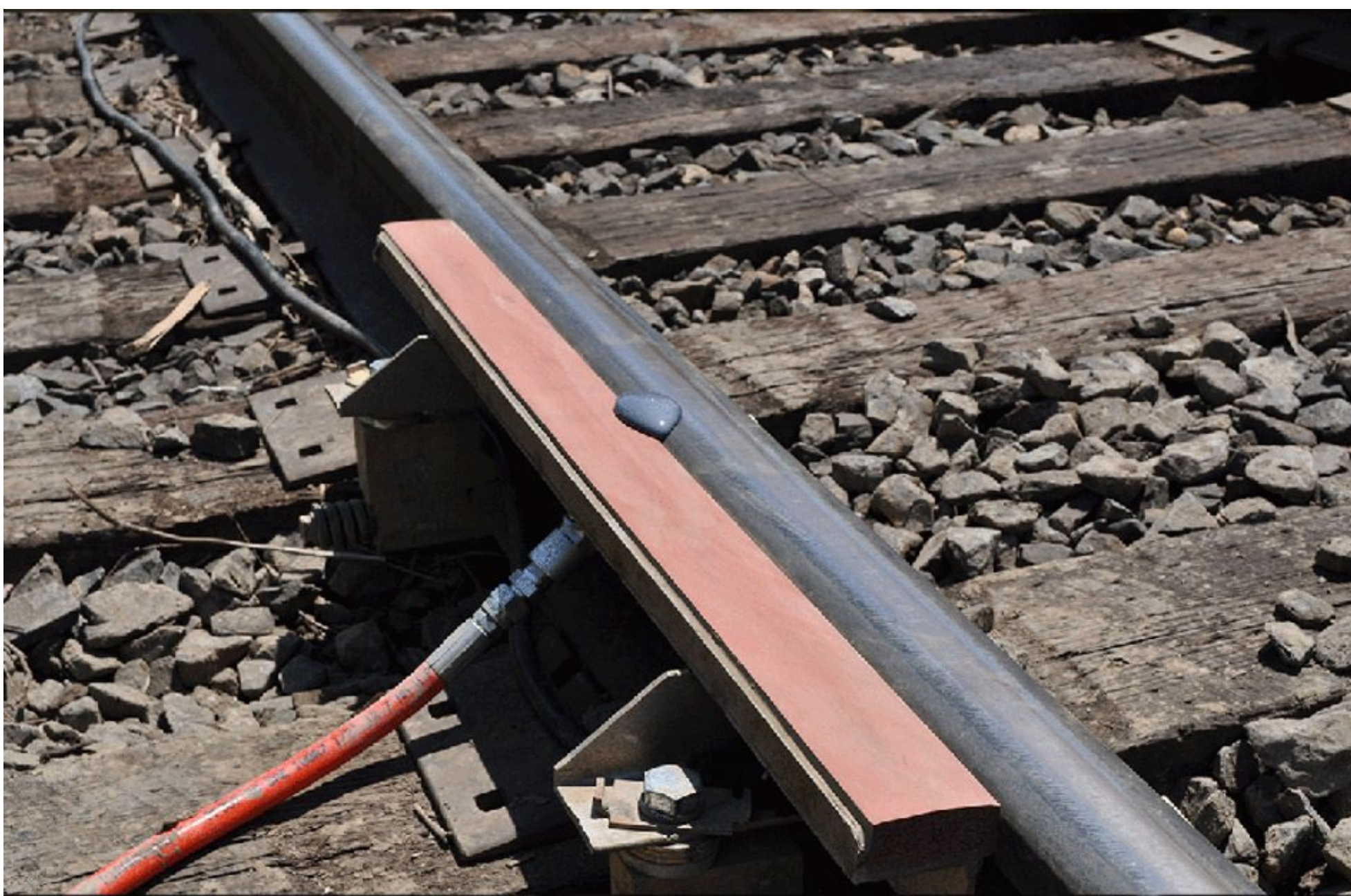
Exemple – Modificateur de frottement monté sur la partie supérieure du rail (référence photographique : LBFoster.eu)
